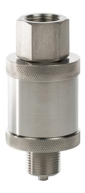
Фильтр жидкости MC-102 для очистки рабочей среды при работе с метрологическим оборудованием. Установленный внутри изделия сетчатый фильтр позволят отсекать различные твердые частицы и взвеси, которые могут оказаться на внутренних поверхностях подключаемого оборудования.
