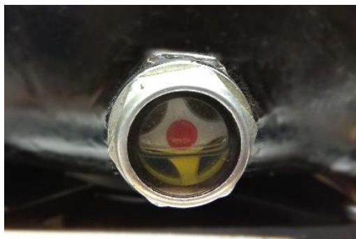
Рисунок 4 – Внешний вид смотрового стекла для просмотра уровня масла.
