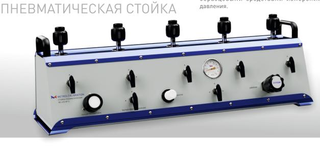
В стойке применяется двухступенчатое регулирование давления при помощи встроенных регуляторов давления для грубой настройки и регулятора объема для точной настройки.
