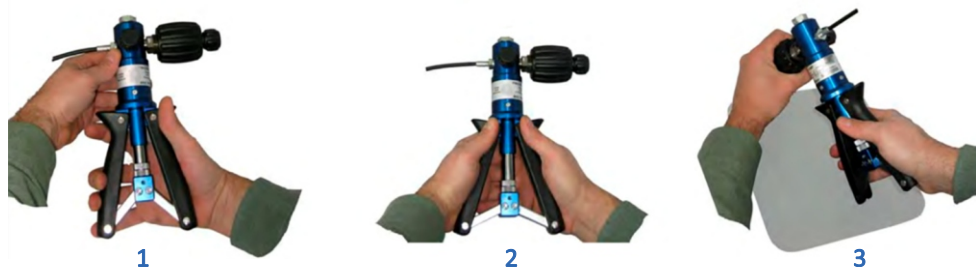
Рисунок 4 – Методы создания избыточного давления
