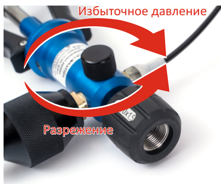
Рисунок 2 – Клапан переключения режимов работы
