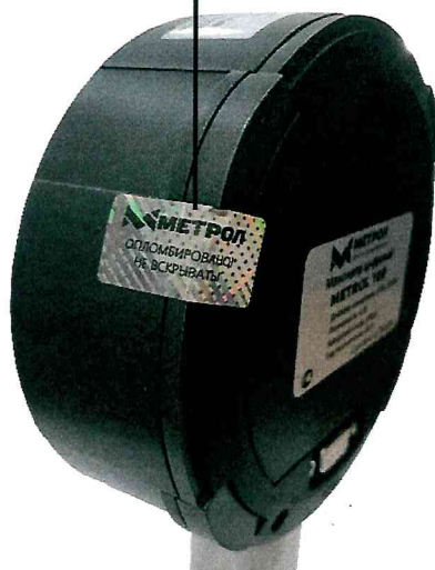
Рисунок 3 - Схема пломбировки цифровых манометров METROL 1X0 от несанкционированного доступа
